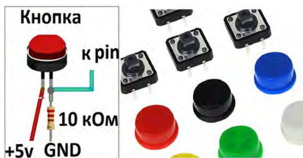
Рис. 1. Схема подключения тактовой кнопки к микроконтроллерной плате
